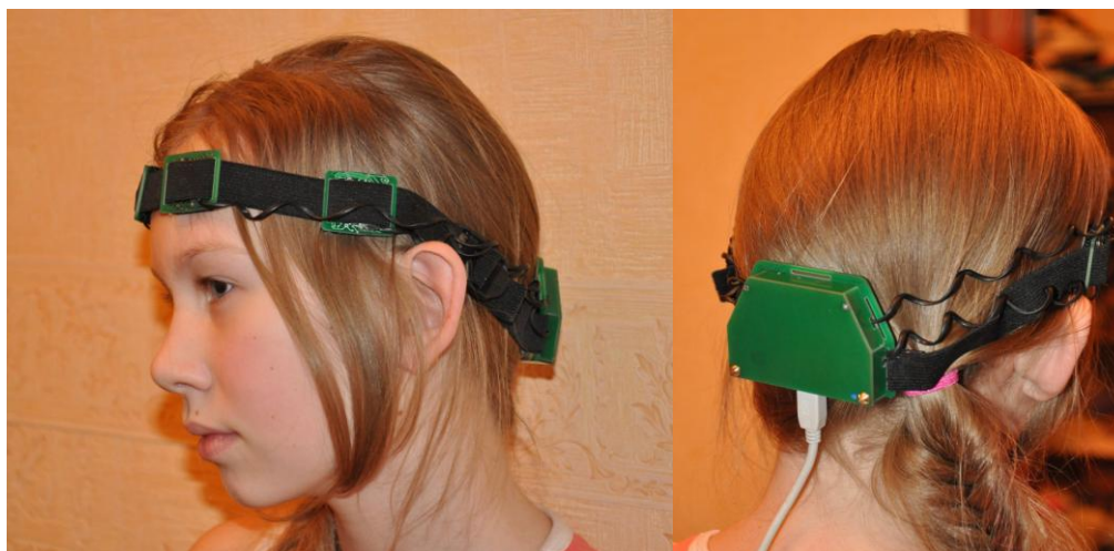
Рис. 1. Расположение прибора «Опторитмограф» на голове
